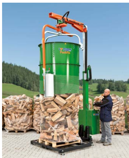
La tambour ne tourne pas et est tiré hydrauliquement vers le haut.
