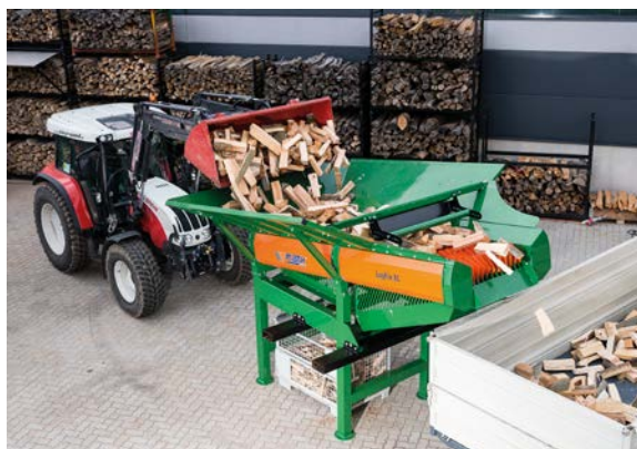
Les résidus de bois du LogFix L sont transportés vers un container adapté ou un tapis d'évacuation disponible en option.
