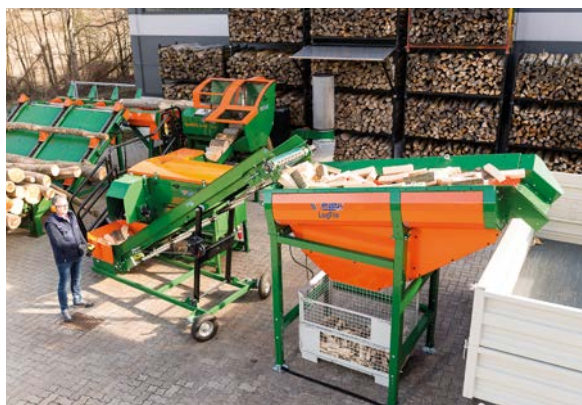
Les résidus de bois du LogFix L sont transportés vers un container adapté ou un tapis d'évacuation disponible en option (image avec option L).
