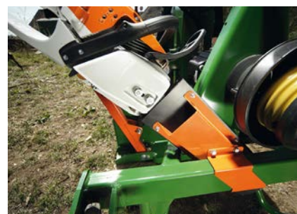
Fixation de tronçonneuse (en option) pour un transport sûr et qui offre la possibilité pratique de poser la tronçonneuse.
