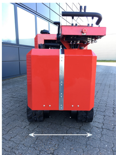
Chenilles rétractées. Largeur de la machine : 775 mm
