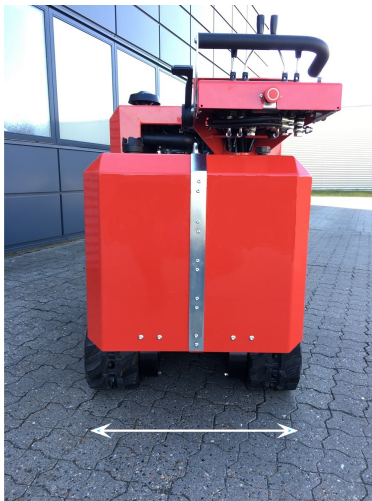
Chenilles rétractées. Largeur de la machine : 775 mm
